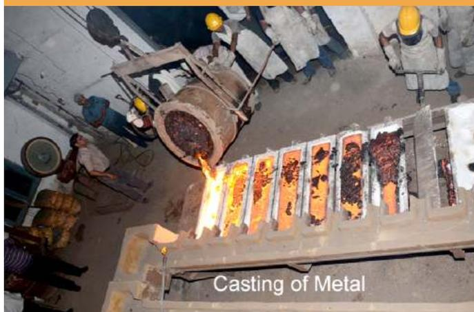
FIGURE 6 : ALLOY CAST IRON (Ni-Cr- Co ALLOY)
