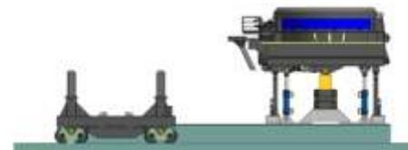
**FIGURE 11 : LADLE CAR IN SHELL CHANGE POSITION**
